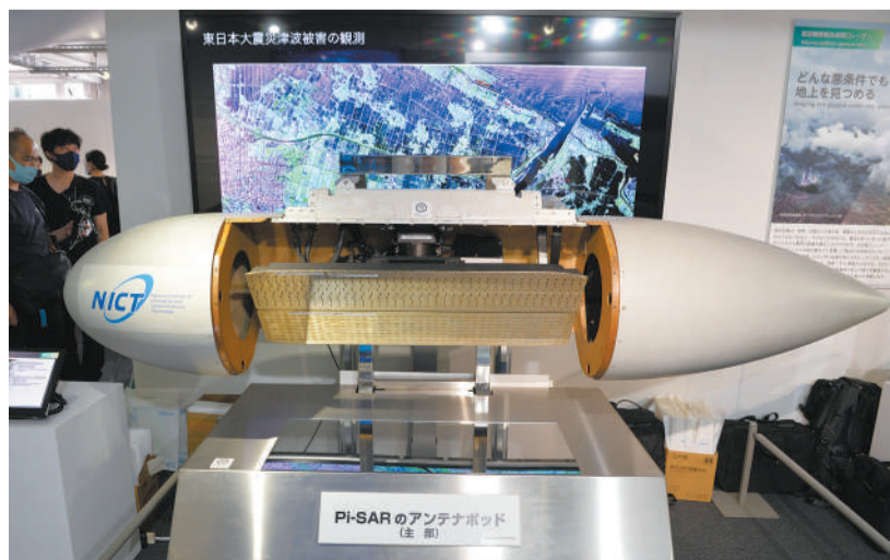
日本情报通信研究机构（NICT）研发的飞机搭载合成孔径雷达“Pi-SAR2”可在高度1万米的上空识别地面30厘米大小的物体，同时高精度观测5公里范围地面情况，在发生灾害时可发挥巨大威力。图为飞机搭载的合成孔径雷达“Pi-SAR”的天线。
