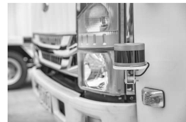
在2021中国国际智能产业博览会上，由重庆两江寸滩保税港区管委会、中国电信重庆公司、联想集团、飞力达和重庆邮电大学共同打造的“5G+智能制造”无人化供应链共享协同平台宣布，重庆两江寸滩综合保税区商业化车路协同智慧物流系统投入商业试运行。该系统在商业试运行中已经实现生产、仓储、运输等环节全流程自动化、可视化，相比物流企业传统作业模式，可有效提高操作效率、操作准确度和库存周转率。图为近日在重庆飞力达供应链管理有限公司拍摄的自动驾驶货车前的激光雷达。 新华社记者 黄伟摄
