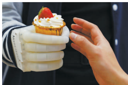
美国麻省理工学院开发的一种充气机械手可以让截肢者实时进行触觉控制。 图片来源:麻省理工学院
