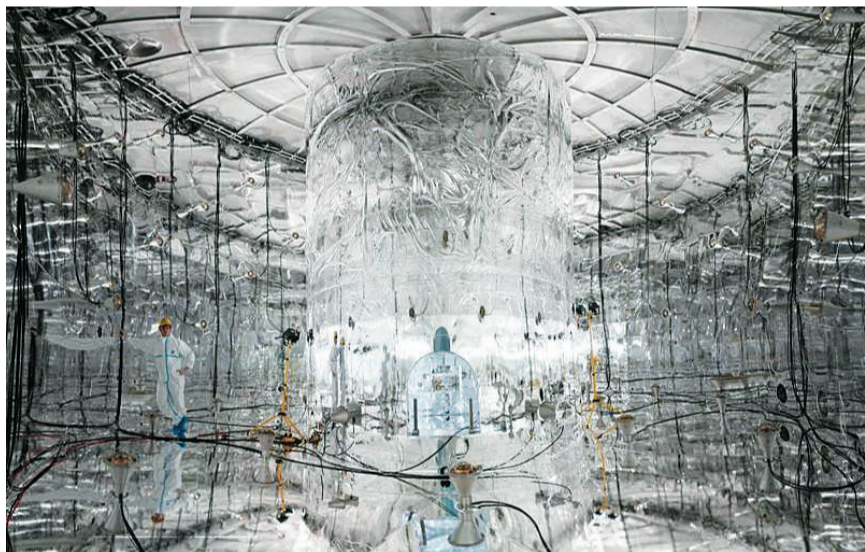
LEGEND-200实验的水箱,低温恒温器使锗-76保持低温。图片来源:《自然》网站
