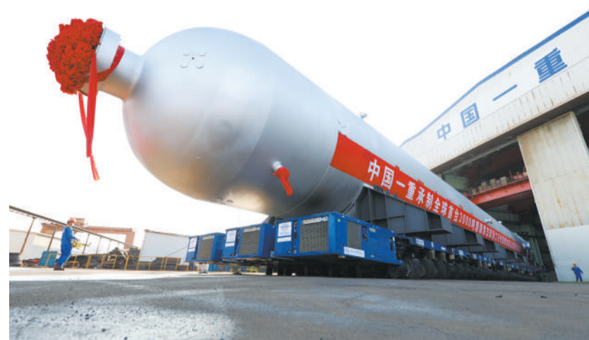
中国一重承制的全球首台3025吨级聚态床锻焊加氢反应器在大连完工发运
