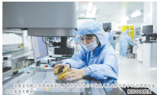
安徽省马鞍山市慈湖高新区易锐光电科技公司技术人员在加工用于5G光网络设备中的高速光模块
