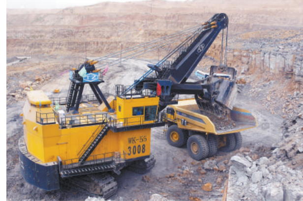
近40年间，太原重型机械集团有限公司创造了400多个中国和世界纪录。图为该公司生产的WK-55立方米挖掘机。 山西省科技厅供图
