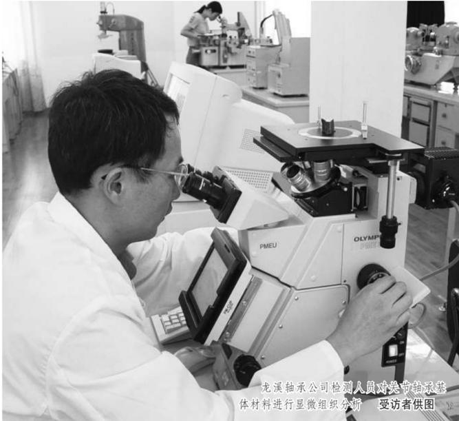
龙溪轴承公司检测人员对关节轴承基体材料进行显微组织分析 受访者供图
