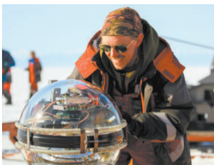
贝加尔湖深水中微子望远镜模块。
