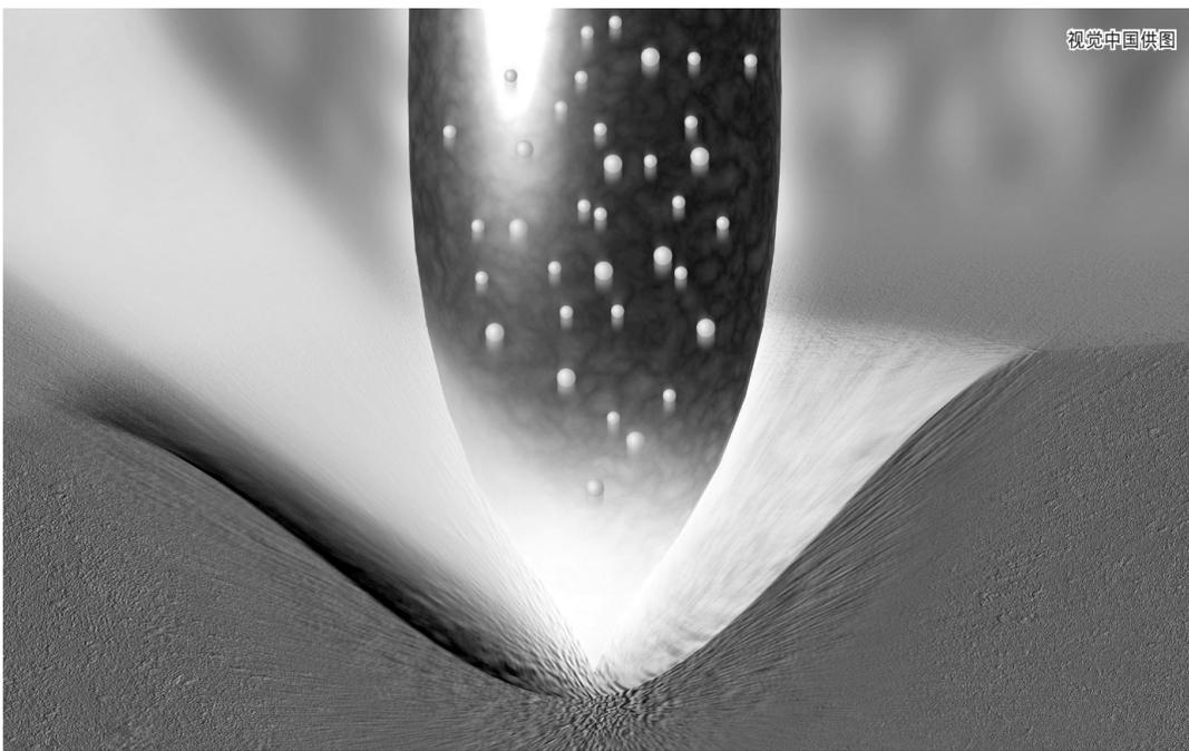
花苞状玫瑰碳材料的内壁像一颗洋葱头,只有一个很小的开口,照进来的光被限制在这个小口袋里,光热从小口逃逸出去的几率小很多,从而提高了光热转换效率。
