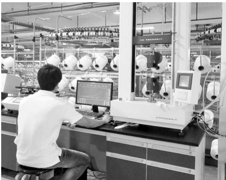
科研人员在检测实验室进行纱线起球测试 受访者供图
