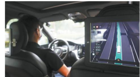
6月27日,上海启动智能网联汽车规模化示范应用,首批智能网联汽车在滴滴出行App上开放服务,用户在滴滴出行App上报名并通过审核后,可预约体验滴滴自动驾驶。图为驾驶员座上的安全员在车辆行驶时两手放在方向盘旁,前排座椅背后的屏幕上实时显示行人、车辆等周边路况。
