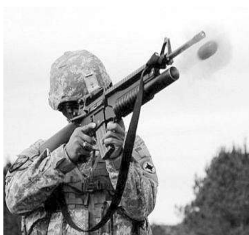
左图:美士兵通过榴弹发射器发射GLUAS。GLUAS被折叠起来并塞入一个胶囊状的壳体内,士兵可以通过40毫米榴弹发射器向目标区域发射。
