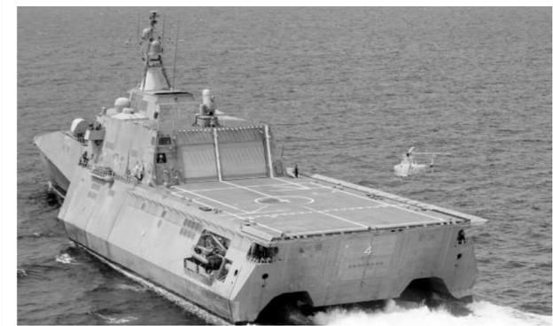
独立级濒海战斗舰采用了三体船结构,飞行甲板宽大,约1000多平方米,相比自由级,它的航空搭载能力更强,甚至可以起降“超级种马”这种重型舰载直升机。图为美国独立级濒海战斗舰正在海上执行任务。
