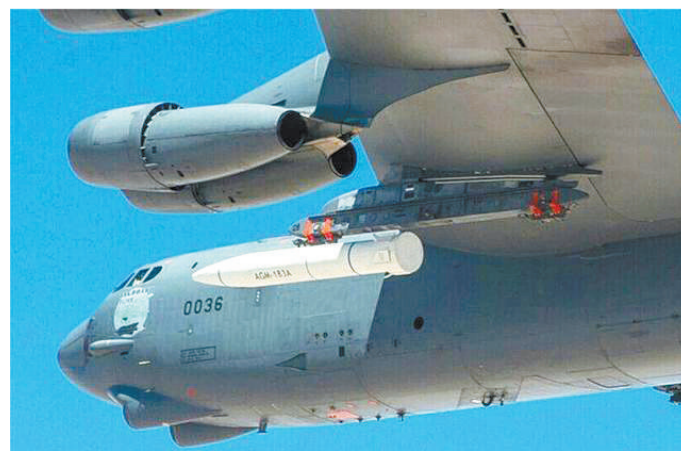
美国空军最新的AGM-183A高超音速导弹被挂载在一架B-52H战略轰炸机的机翼挂架上。图片来源:美国空军官网
