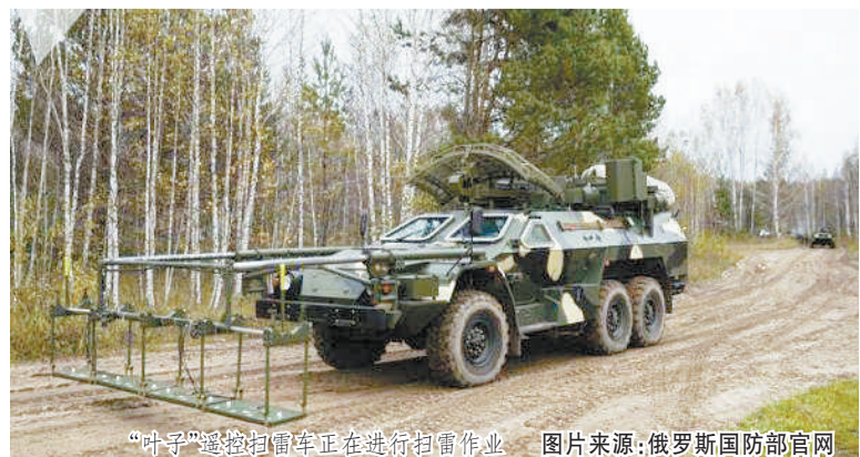
“叶子”遥控扫雷车正在进行扫雷作业。图片来源:俄罗斯国防部官网
