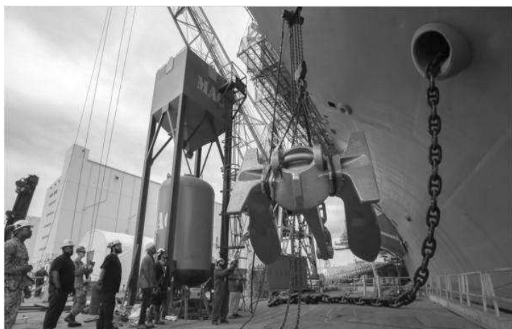
造船厂工人将经过翻修的“企业”号旧锚安装到“华盛顿”号航母上
