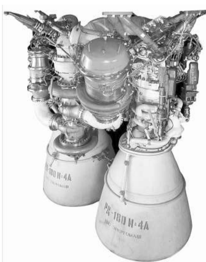
俄罗斯RD-180火箭发动机,是一款双燃烧室、双喷嘴的火箭发动机。该发动机由RD-170系列衍生而来,采用共享涡轮泵。
