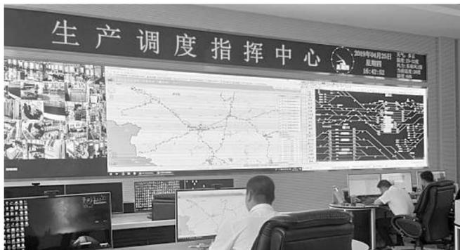
机务段应急值守人员通过CMD系统对机车运行状态进行实时监控，当机车出现故障时，远程指挥乘务员应急处理机车故障。
