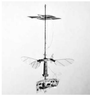
RoboBee X-Wing 机器人。
