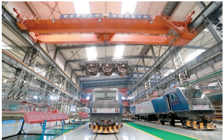
苏家屯车务段在和諧机车检修中严格执行作业标准,以科技创新强化检修入手,提高机车检修科技化水平。图为该段职工正在进行和谐机车解体检修作业。
