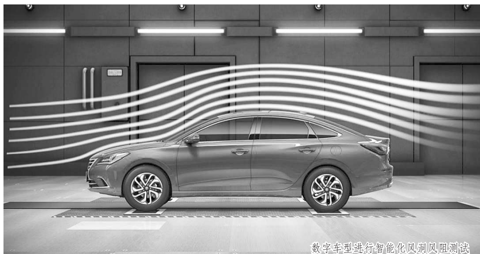
数字车型进行智能化风洞风阻测试
