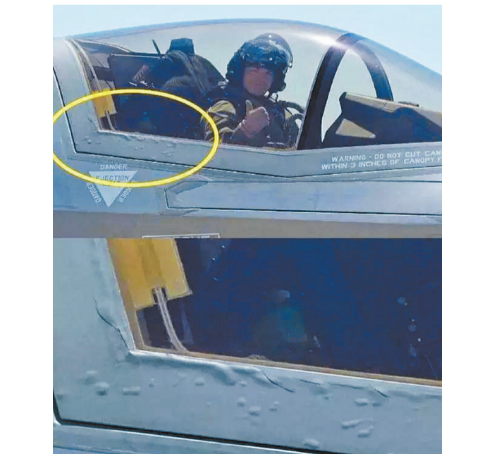
这架F-35战斗机座舱边缘的隐身涂层,出现了大面积的开裂、起皮、冒泡。有的“水泡”还出现了明显的裂痕,作为一架隐身战斗机,这绝对是致命的。
