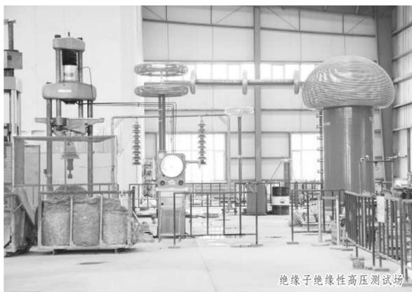
绝缘子绝缘性高压测试场
