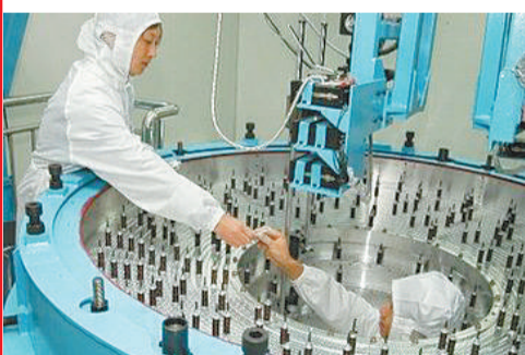
第三代北京谱仪于2008年投入运行,图为科研人员正在安装北京谱仪的主漂移室。
