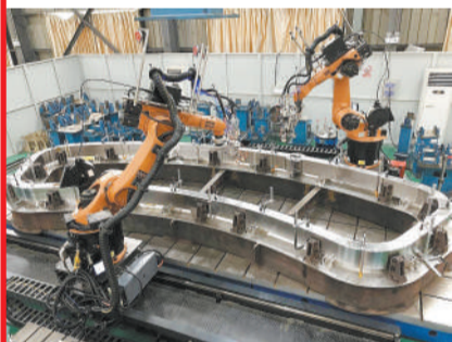
中方为ITER研发的大功率激光焊接系统。
