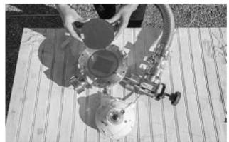
新设备顶层是太阳能吸收器,底层的材料执行冷却任务。 图片来源:每日科学网
