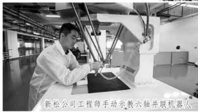
新松公司工程师手动示教六轴并联机器人
