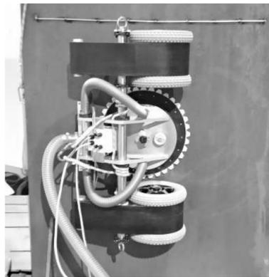
除锈爬壁机器人“机器壁虎”
