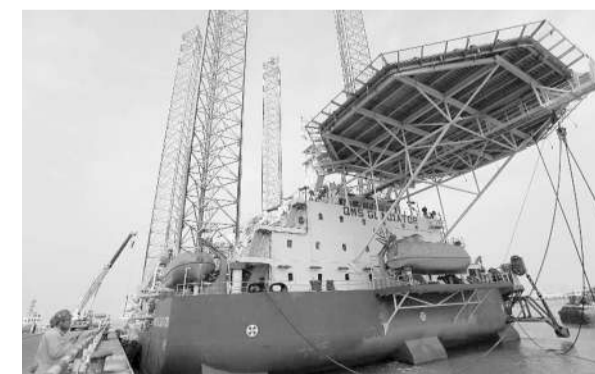
青岛海西重机自主研发的多功能自升式海工平台
