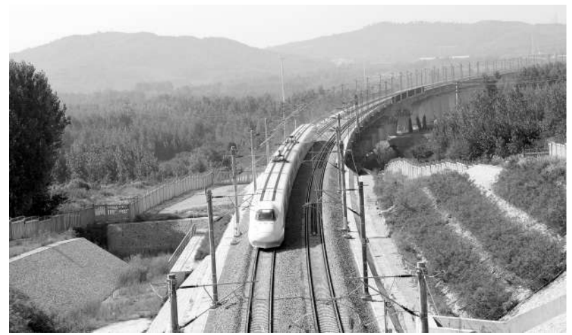
国庆期间，即将于年底通车的青岛至连云港（青连）铁路正加紧联调联试。青连铁路是我国首条串连起海港与铁路的联运大通道，设计时速200公里，客货共运，总长194公里。图为中国中铁正配合试验动车组检测接触网数据。本报记者 郝阳摄
