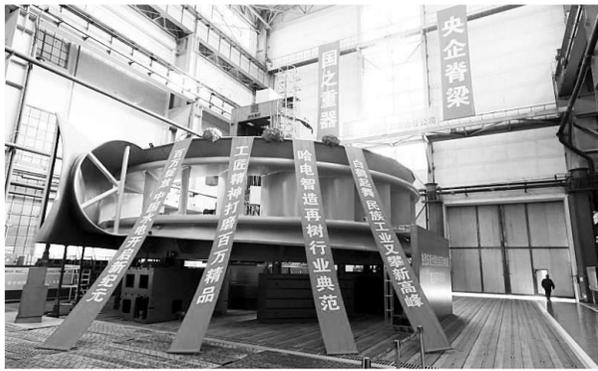
世界单机容量最大的白鹤滩水电站1000MW混流式水轮发电机组精品座环制造成功
