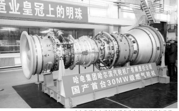
哈电集团自主研发的国产首台30MW级燃气轮机
