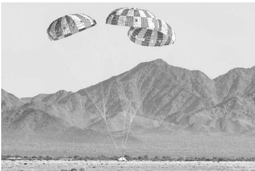
最终测试飞行中展开的降落伞系统。
