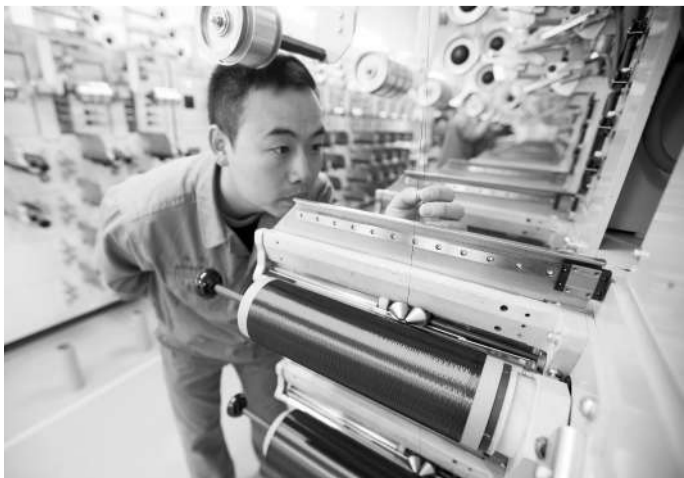
一根成人手指粗的碳纤维复合材料可承受约40吨到80吨的重物——太原钢铁集团与中科院山西煤化工所研发的T800高端碳纤维,使中国碳纤维生产技术达到世界一流水准。图为研发团队骨干杨哈在生产线上作业。视觉中国
