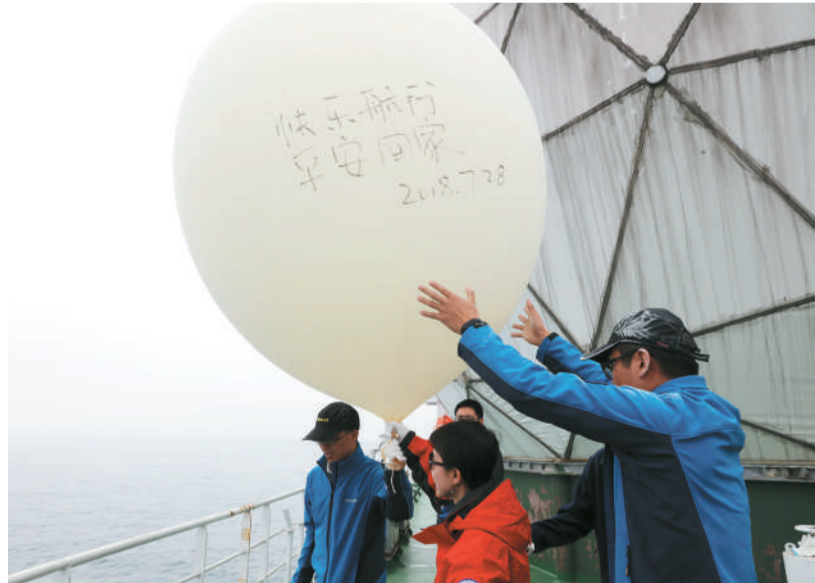
中国第九次北极科学考察队开展气象观测 7 月 28 日,“雪龙”号上的中国第九次北极科学考察队成员在白令海公海区域释放探空气球,用于观测北极地区气象要素变化特征。新华社记者 申敏摄
