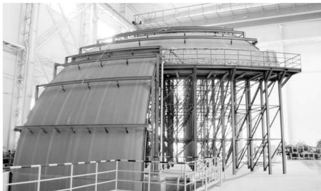
安全壳穹顶水发配试验装置
