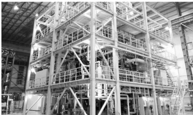
非能动堆芯冷却系统试验装置(ACME)
