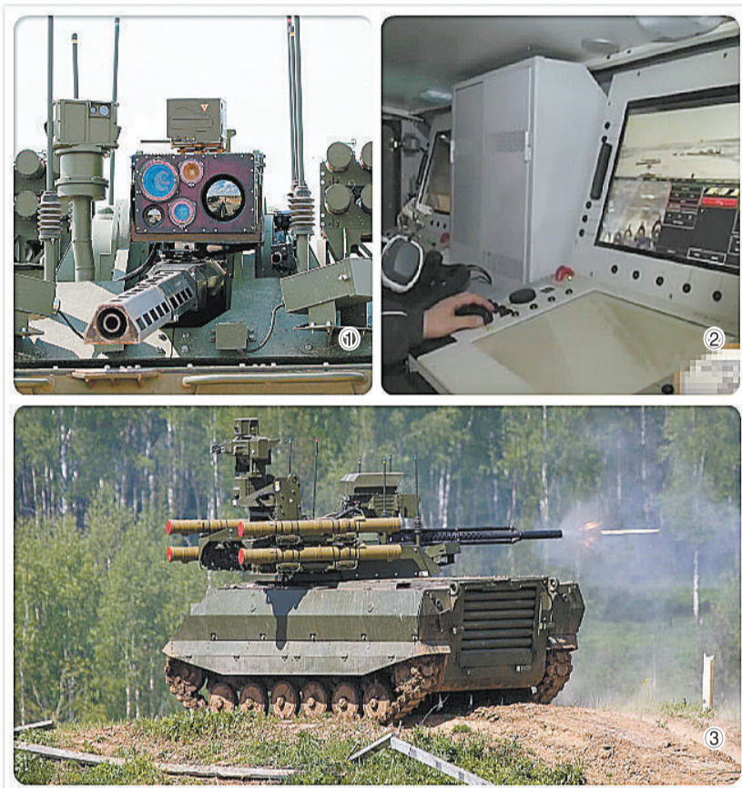
图1“天王星”-9的30毫米2A72主炮特写。图2“天王星”-9的武器系统操控台,标准的转球+鼠标搭配。图3“天王星”-9使用30毫米自动炮射击。
