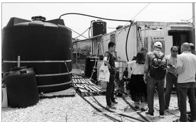
为除去药物成分,他们在海法南部的Nir Ezion生活废水处理厂边建立了“先进废水处理”试验中心,寻求高效净水途径。日前,中农富通公司代表团到试验中心现场考察。以色列理工大学研究人员表示,他们首先采用超滤对三级出水进行预处理,然后用单级或多级反渗透(RO)进一步处理,最终获得纯净水。
