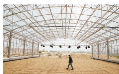
由中国科学院沙漠头沙漠研究试验站负责建设的,中国北方不同气候带沙区水量平衡自动模拟监测系统蒸渗仪群,于近日建成并进入调试阶段。该蒸渗仪群实现北方沙区水量平衡的模拟集成研究。图为 5 月 12 日拍摄的大型称重式蒸渗仪群。新华社记者 金立旺摄
