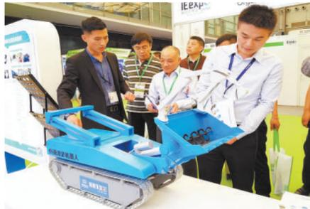
5月5日,记者在第十九届中国环博会上看到,北京恒通环境公司研发的具有自主知识产权的新一代下水管道清淤机器人。该机器人专为市政箱涵管道检测、清淤设计,可针对不同工况,选装不同类型的履带底盘和前端工作装置。
