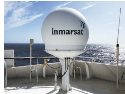
放置在“向阳红10”船罗经甲板上的2M带宽海事卫星通讯系统天线 刘园园摄
