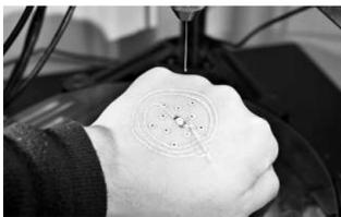
打印在手上的3D电子元件。
