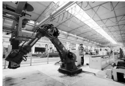
车钩作为连接列车的重要配件,检修质量和尺寸精度要求都非常高,中铁沈阳局苏家屯车辆段引进机器人,有效提高车钩上下料作业效率和安全性及检测精确度,生产效率提高了39.8%,故障率降低了8.1%。图为在检修作业中使用的机器人。 巴一夫摄
