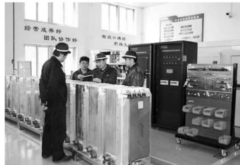
近几年和谐型电力机车大量运用,苏家屯机务段技术研发中心打破国外技术壁垒,先后完成了和谐机车交流装置、电子部件、制动夹钳、相位模块和电源柜等79种关键部件的自主检修,取得了高级维修资质,让一台台代表国家最先动力技术的和谐机车安全行驶在万里铁道线上。图为苏家屯机务段技术总监、技术研发中心主任张兴宇指导工人对和谐型机车的充电单元控制柜进行维修。 吕森摄
