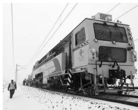
中铁沈阳局坚持创新驱动发展,科学运用大型智能化养路机械,定期对线路进行维护检修,在提高生产效率的同时,也为线路安全质量提供了保证。图为被称为“大蜜蜂”的DG0832大型捣固车正在线路上进行捣固作业。 陈明摄
