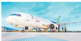
2017年5月5日14时,中国第一架完全自主知识产权的国产干线客机C919成功上天。随着C919成功着陆,标志着国产大飞机与波音、空客分庭抗礼的时代正式开启。C919全长38.9米,连翼展35.8米,高12米。最大起飞重量72吨,最大航程5555公里,最大载客量190座。
