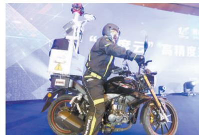
当测绘人员骑着摩托车,在乡间哼着小曲惬意行驶时,一款搭载在摩托车上的便携式车载激光扫描系统正在快速运行着。当采集到的数据与处理系统相结合后,就能在终端实时还原真实的场景。1月20日,在南京举行的速度中国“智绘”峰会上,一款三维激光扫描设备、卫星定位模块、惯性导航装置、车辆编解码器等多种传感器同步集成于一体的系统让人眼前一亮。
