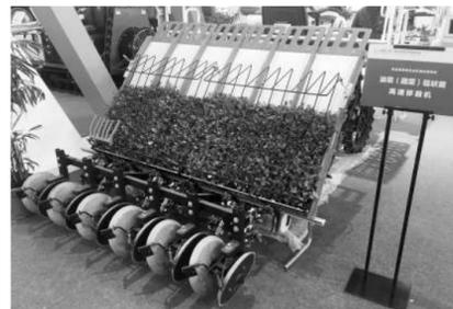
农业部南京农机化研究所同扬州大学联合攻关创新的油菜毯状育苗及机械化移栽技术,整机实际作业效率可达5—8亩/小时,是人工移栽的60倍。目前,该技术以400万元高价转让给日本洋马农机,实现了我国农业机械化技术向世界农机强国“逆向”转让的奇迹。 顾磊摄
