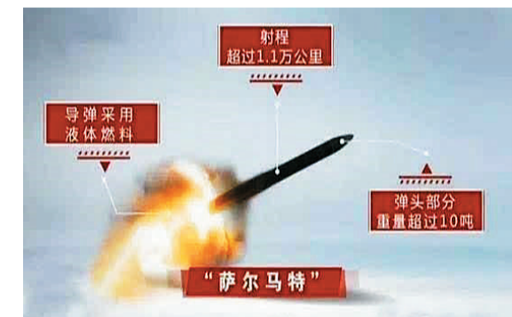
RS-28“萨尔马特”是一种重型液体燃料洲际弹道导弹,爆炸当量2500万吨,弹头重约10吨,能携带10-15枚分导核弹头...
