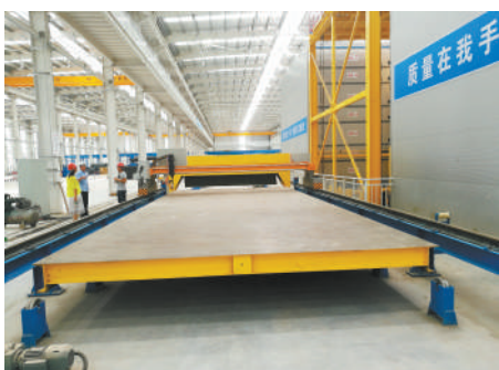
新密产业化基地内的装配式预制构件生产线
