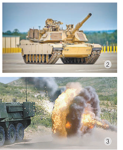
图①以色列“梅卡瓦”坦克上“战利品”主动防御系统雷达天线特写。 图②M1A2“艾布拉姆斯”主战坦克。 图③内蒙古举行的“装甲与反装甲日”特别活动上,国产“GL-5”型主动防御系统(简称APS)拦截89式120毫米反坦克火箭弹特写。
