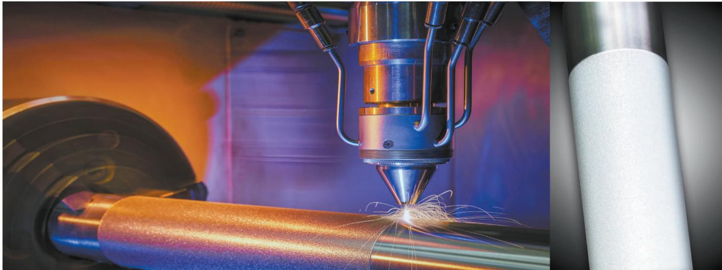
超高速激光熔覆技术
