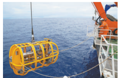
科考队员拖放6000米集成化光学拖体入水探测。本报记者 刘垠摄
